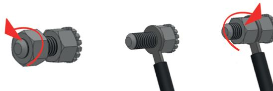
**Bild 4. Der Anschluss des Gerätes an die Einrichtung zum Potentialausgleich**
