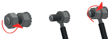
Figura 7. Conexión del equipo a una instalación equipotencial.
