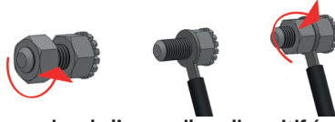
Figure 7. Connexion de l'appareil au dispositif équipotentiel.
