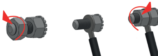
Figure 10. Branchement de l'appareil au dispositif équipotentiel
