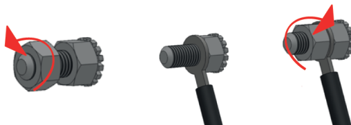
Figura 10. Conexión del equipo a una instalación equipotencial.
