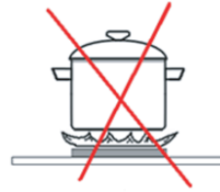
Der Boden ist für diesen Brenner zu klein
